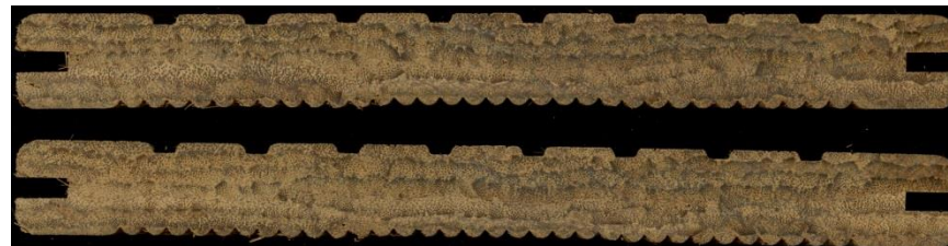
Proben der Serien PRIMUS (oben), ELEGANCE (Mitte) und XXL (unten) deren Enden (Querschnittsflächen) um 2 cm gekürzt (abgelängt) wurden
